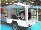
Arrière à quatre points pivot dans la cellule + la porte-moteur de secours.
